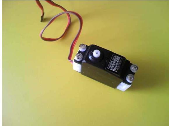
2.1 サーボの両端に方形マウントを M3x8 タービンねじで組み付ける。
