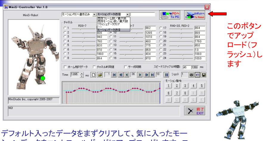
デフォルト入ったデータをまずクリアして、気に入ったモーションデータをコントロールボードにアップロードします、ロボットを単独動作させます。
