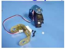
●ネジには種類がありますのでサーボマウントの穴に合わせて使用します(穴に対して2~3mm長さに余裕があります)
