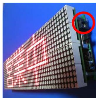
図2 スイッチと外部端子
